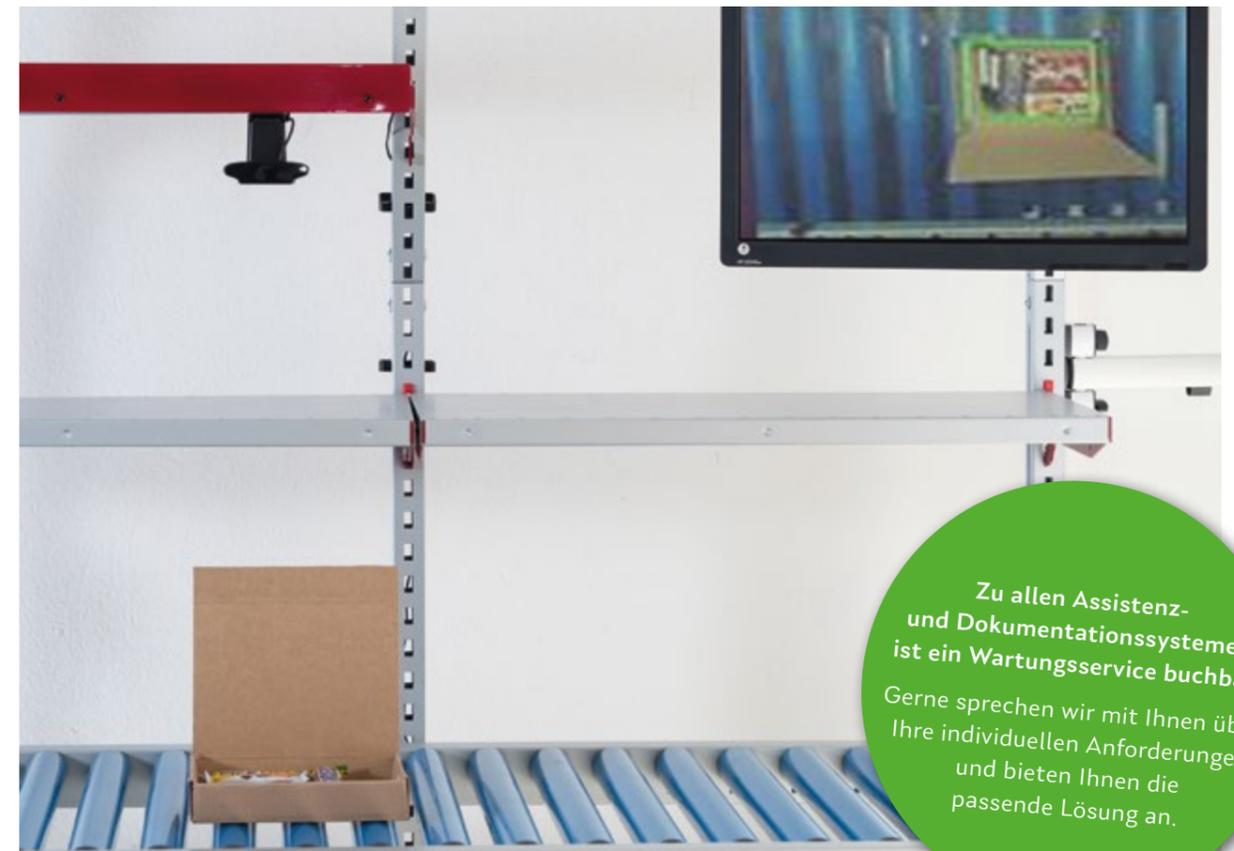
InspeTable sorgt dafür, dass Abweichungen und Fehler frühzeitig und zuverlässig erkannt werden – und zwar bevor die Ware beim Kunden ist. Das bildbasierte System führt einen Abgleich mit den eintrainierten Soll-situationen durch und kann sowohl einzelne Artikel und deren Lage bzw. Position als auch das Gesamtbild analysieren. Machine Learning macht es möglich, dass dabei je nach Anwendungszweck nicht nur zwischen falsch oder richtig unterschieden werden kann, son-
